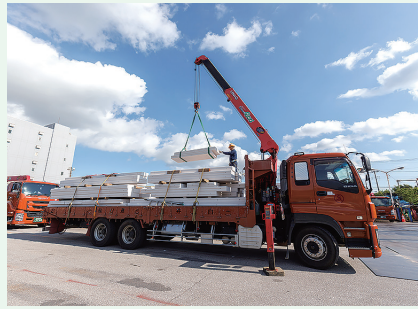
大型ユニック車に建設資材を積載。積載にあたっては荷崩れを防ぐために、適切な積み付けや固縛が求められる
